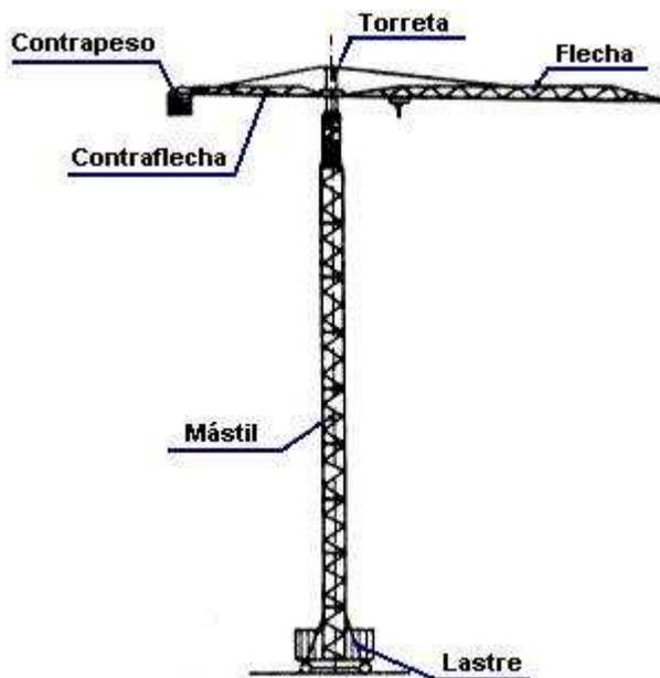
La torre de la grúa puede empotrarse en el suelo, inmobilizada sin ruedas o bien desplazable sobre vías rectas o curvas. Las operaciones de montaje deben ser realizadas por personal especializado. Asimismo las operaciones de mantenimiento y conservación se realizarán de acuerdo con las normas dadas por el fabricante.
