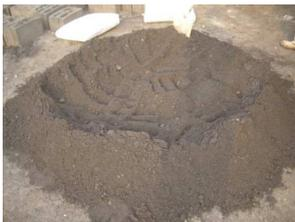
La arena o árido fino es el material que resulta de la desintegración natural de las rocas o se obtiene de la trituración de las mismas, y cuyo tamaño es inferior a los 5mm. Para su uso se clasifican las arenas por su tamaño. A tal fin se les hace pasar por unos tamices que van reteniendo los granos más gruesos y dejan pasar los más finos.
