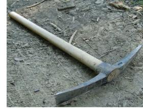
Consta de una parte de acero y un mango de madera. El mango de madera es perpendicular a la parte metálica. Su parte metálica termina en punta en uno de los extremos y plano con borde ancho y cortante en el otro. El extremo que termina en punta es usado en suelos duros y con presencia de piedras, mientras que el extremo ancho es usado para suelos blandos, excavaciones y desterronado.
